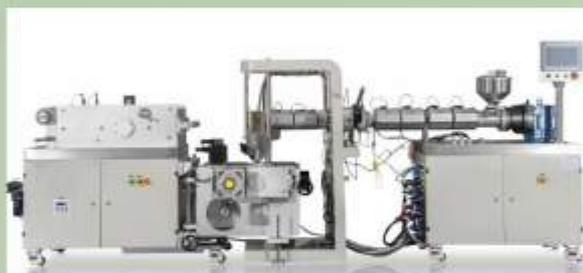
图1 双螺杆挤出流延拉伸机
